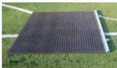
Rubberinsleepmat. Bij dit vegen komt er vaak een hoeveelheid rubber op het kunstgras te liggen. Om dit weer in te slepen gebruiken we ook hier een rubber insleepmat. Deze mat is langer dan bij zandvelden, namelijk 150 lang, dit is nodig om de rubberinfill korrels weer tussen de vezel van het kunstgras te krijgen. Dit slepen doen we haaks op de veegrichting van de gebruikte bezem. Op die manier wordt het veld weer mooi egaal groen. Afmeting 200 x 100 cm Art.nr 3010 per stuk € 275,00
