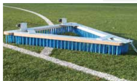
Onderhoud bezems voor rubberinfill voetbalvelden. Ook op voetbalvelden vegen we met de blauwe driehoekbezem wekelijks in verschillende richtingen. Zowel in de lengte als breedte van het veld. Dit vegen doen we om de rubberverdeling te optimaliseren en om de kunstgrasvezel weer te liften, dus het tegengaan van platliggende vezels. De blauwe bezem heeft een holle bezetting, wat voorkomt dat de bezem volloopt met rubberinfill. Art.nr 3008 per stuk € 500,00
