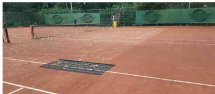
Sleepmat "Super Clean". Ontwikkeld om snel en eenvoudig bladeren en dennennaalden op te nemen. Het reinigen gebeurt door de sleepmat uit te kloppen. Gelijktijdig zorgt de sleepmat voor een egalisering van het baanoppervlak. De mat moet altijd vlak op de grond liggen. Werkbreedte 200 x 80 cm. Inclusief trekkoord.
