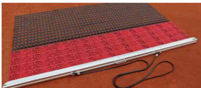
Roset plan. Voor het slepen van gravel, kunstgras en zand ingestrooide banen. Aluminium trekbal met kunststof tegels en sleepnet. Werkbreedte 200 x 150 cm. Inclusief trekkoord.
